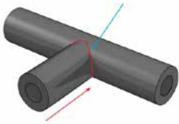
10. Наносим клей Ру-флекс на обе стороны продольного шва, как только клей подсохнет, соединяем склеиваемые поверхности путем сдвливания по стыку кле-
