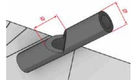
1. Берем трубку РУ-ФЛЕКС такого диаметра и толщины, что и теплоизоляция основного трубопровода.
