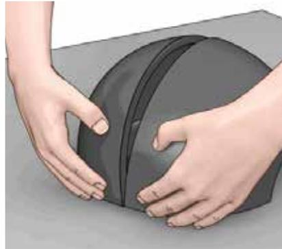
соединяем края, выравнивая торцы отвода и теплоизоляционной трубки.
