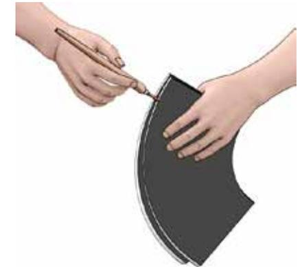
угла. Равномерно, тонким слоем наносим клей Ру-флекс на торцы большего радиуса.
