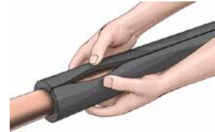
4. Проклеиваем лентой Ру-флекс СТ/Ру-флекс СТ-СК или Ру-флекс ВТ/Ру-флекс ВТ-СК (в зависимости от марки теплоизоляционного материала) продольные и поперечные стыки, предварительно очистив поверхность (при необходимости обезжирить).
