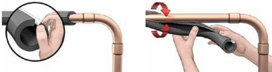
1. Отодвинув кромки самоклеющейся трубки, надеваем тепловую изоляцию на трубу.
