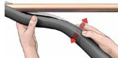
3. Оборачиваем заготовку изоляционной конструкции вокруг трубопровода.
