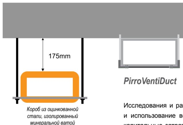
Кроме того, благодаря своей технологичности и малому весу, воздуховоды PirroVentiDuct могут устанавливаться в зонах, где сложна или невозможна установка коробов из оцинкованного железа.
