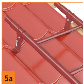
Установка кровельной лестницы на композитную кровлю
