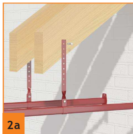
Установка поручней на парапет с помощью L-образных кронштейнов
