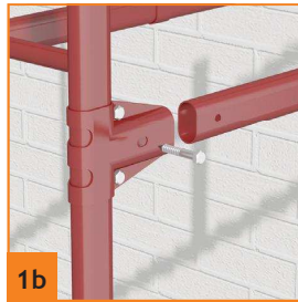
Установка подвесных кронштейнов с креплением к карнизной доске
